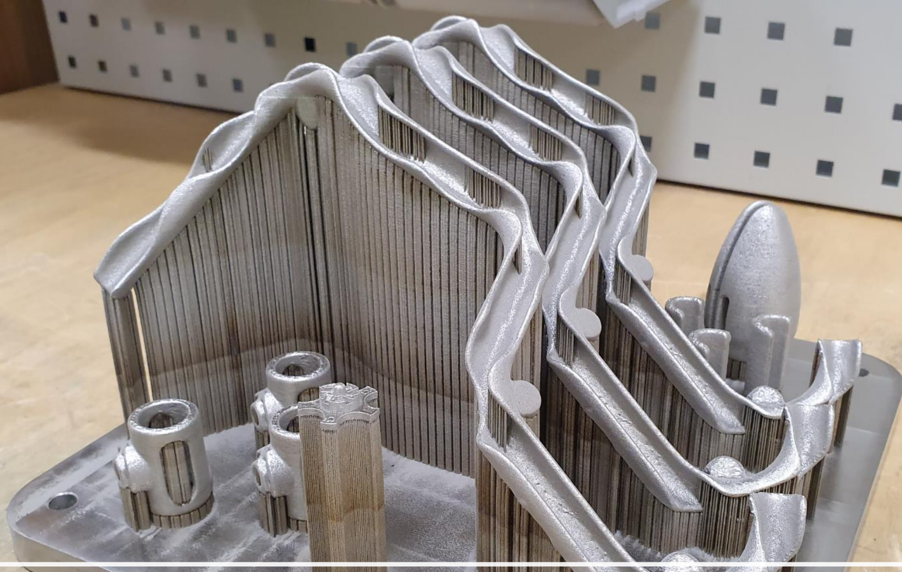
Kavity (kontrolní přípravky), 316L, doba tisku 70 hodin
